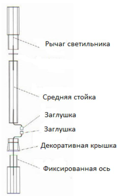
4.2 Вытащите рабочее освещение, вставьте фиксированную ось в отверстие переднего рычага светильника и закрутите его болтами М5х12.
